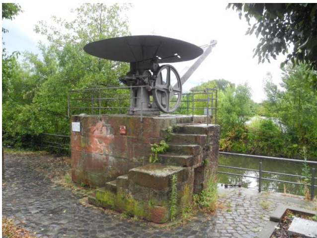
Ein handbedienter Verladekran aus dem 19. Jahrhundert auf einem barocken Sandsteinsockel aus dem Jahr 1770 diente dazu, die Marktschiffe zu be- und entladen.
